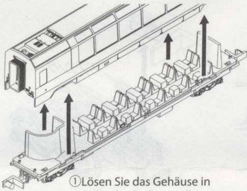
① Lösen Sie das Gehäuse in Höhe der Drehgestelle vom Chassis durch vorsichtiges Auseinanderziehen.
