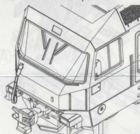
④ Setzen sie den Schneepflug nun wieder ein. Die Kupplung sollte frei in die mittlere Position schwingen können.
